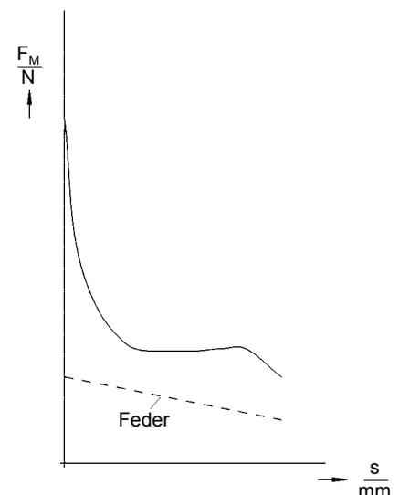
Bild 2: Magnetkraft-Hub-Kennlinie
