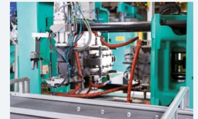
**Kunststoff-Spritzguss mit automatisierter Teileablage**
