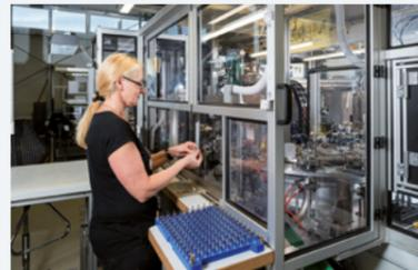
**Vollautomatische Montage und Dichtungsprüfung von Tuben**
