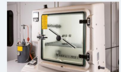
Kesternichkammer für Korrosionsprüfungen
