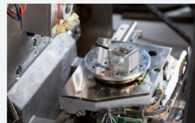
Rasterelektronenmikroskop für Werkstoffanalyse
