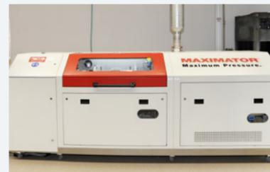
Hochdruckprüfstand bis 1000 bar
