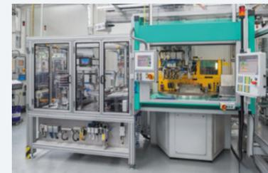
**Vollautomatische Kunststoffummantelung von Magnetkörpern**
