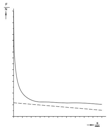
Bild 2: Magnetkraft-Hub-Kennlinie
