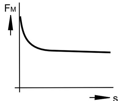
Bild 2: Magnetkraft-Hub-Kennlinie
